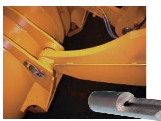
Lubricación de los puntos de engrase. Gomas flexibles y reforzadas, tubería rígida de acero con un diámetro de 10 mm (ver foto)
